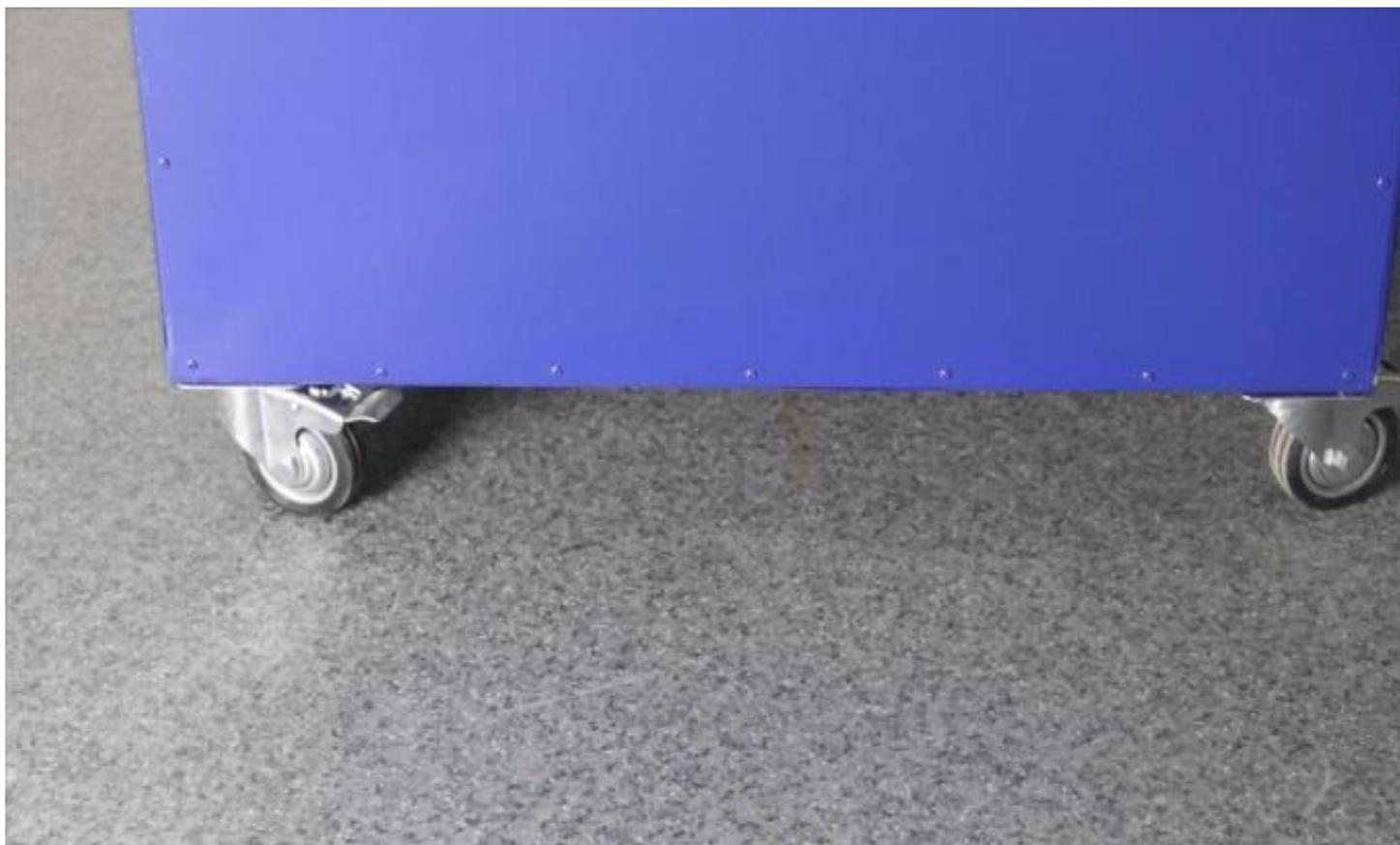
**Колёса станции очистки картриджей** необходимы для перемещения оборудования внутри помещения одним сотрудником. Они позволяют снизу пронести шнуры питания других устройств и делает оборудование чуть выше. Они имеют надежный фиксатор, который позволяет не ездить оборудованию. Четыре единицы имеются в комплекте с оборудованием и нуждаются в установке после распаковки оборудования.
