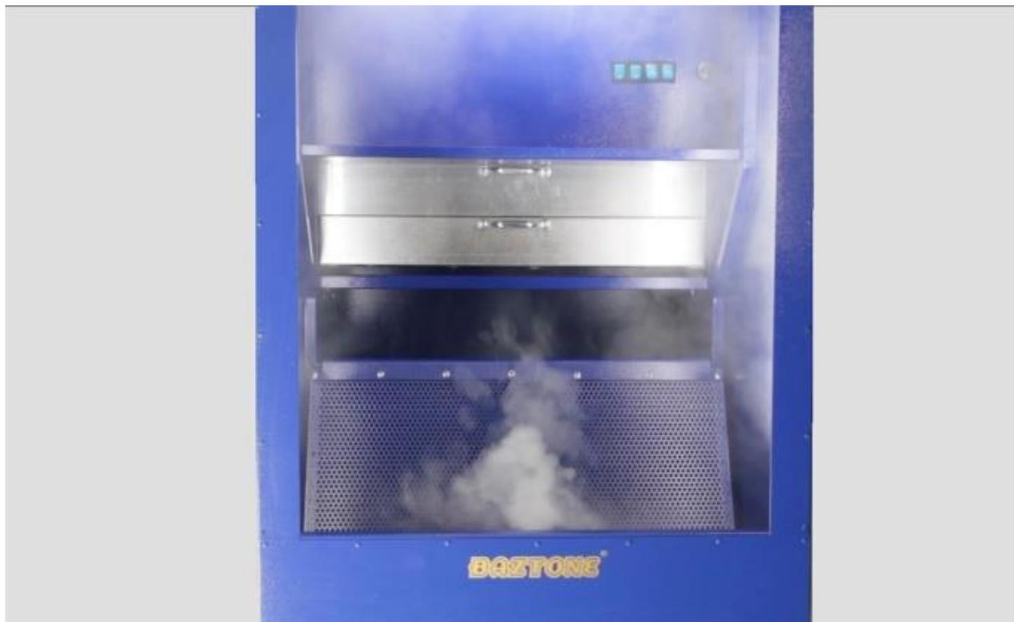
**Вытяжная система станции очистки картриджей** очень мощная и эффективная. В системе фильтрации воздуха применяется два фильтра. Первый фильтр это фильтр грубой фильтрации, который задерживает большие частицы тонера. Самые мелкие частицы задерживаются в фильтре абсолютной очистки HEPA, который установлен после фильтра грубой фильтрации. Оба фильтра прослужат минимально один год при объеме до 1000 картриджей в месяц.
